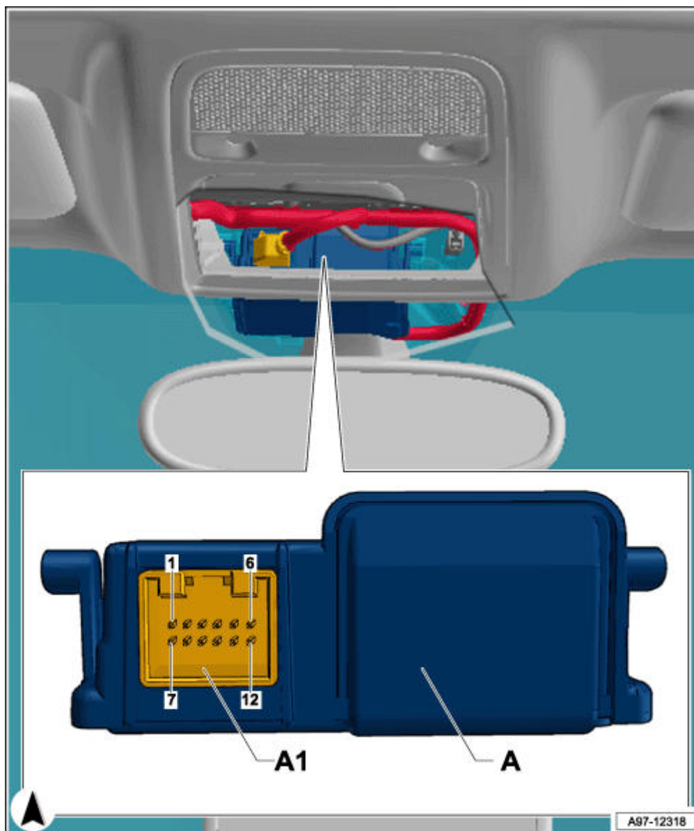
A - 驾驶员辅助系统的前部摄像头 -R242- A1 - 12 芯插头连接 -T12ac- , 黑色
