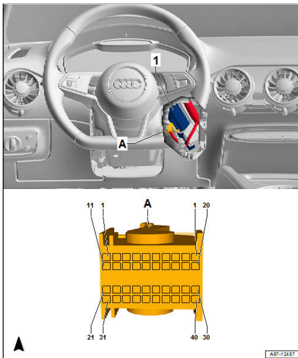
1 - 进入及启动许可控制器 -J518- A - 40 芯插头连接 -T40a- , 黑色
